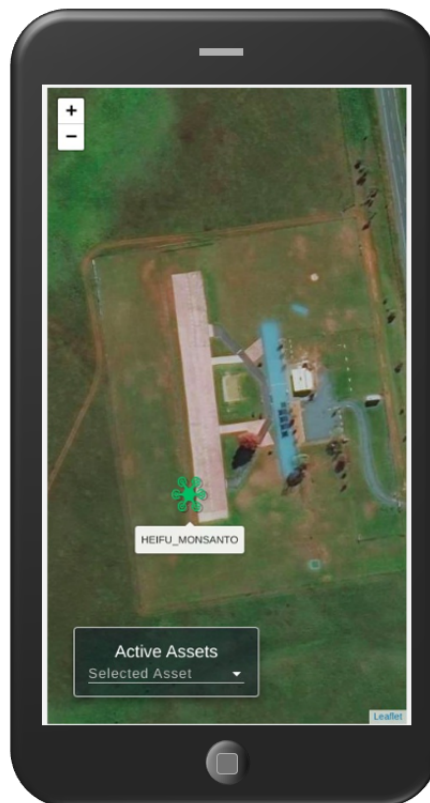
Figura 1.11: A app reconhece qual o drone presente naquela localização geográfica. Heifu Monsanto. Este foi o drone usado para conduzir a maioria dos testes de debugging. É simulado no computador do professor orientador, onde este define as coordenadas geográficas para a simulação.
